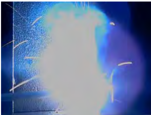
Hoher Strom = Einbrand
